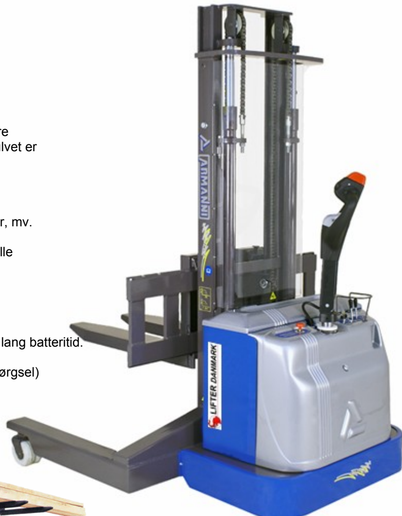
Drivhjul ophængt i støddæmpersystem for optimal kontakt med gulvet
